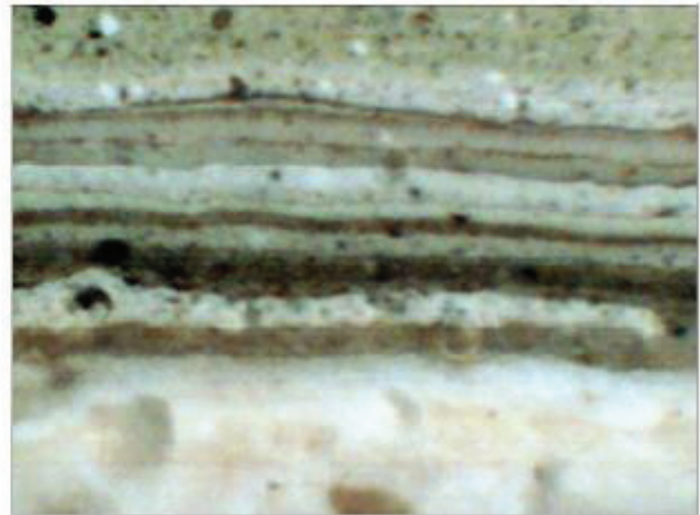
Abb. 1 Mikroskopaufnahme 200x, Schichtenpaket, (unten Kalkstuck). Bader Str. 3, Ostfassade, 1.Obergeschoss, Solbank. 2004. Foto: Kusch
