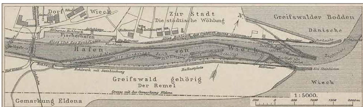
Abb. 7 Greifswald, Wieck/Eldena. Darstellung des Wiecker Hafens mit den Baumaßnahmen um 1860. Dabei wurde eine Landzunge im heutigen Flussverlauf abgetragen sowie das Hafenbecken vertieft und erweitert. Abbildung: Ministerium der öffentlichen Arbeiten 1904, Blatt 17
