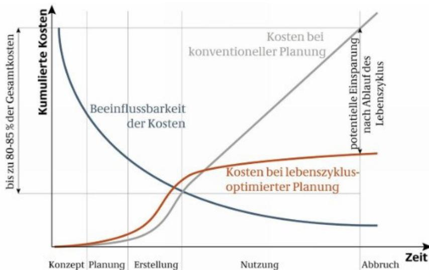
**Abbildung 2:** Kostenentwicklung bei Lebenszyklusoptimierter Planung<sup>1</sup> - Für die Wirtschaftlichkeit von Gebäuden und Anlagen sind die Kosten für den Gebäudebetrieb maßgeblich und lassen
