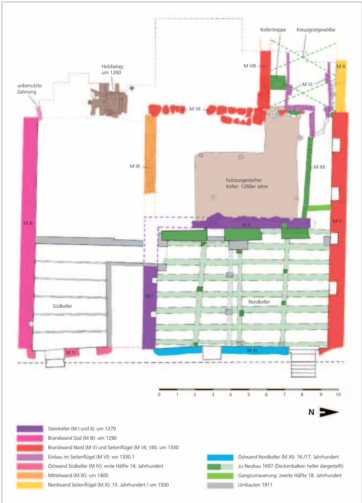
Abb. 5 Greifswald, Fleischerstraße 17. Baualtersplan für die Kellermauern und die Grabungsfläche. Zeichnung: T. Rütz (1998/2014)
