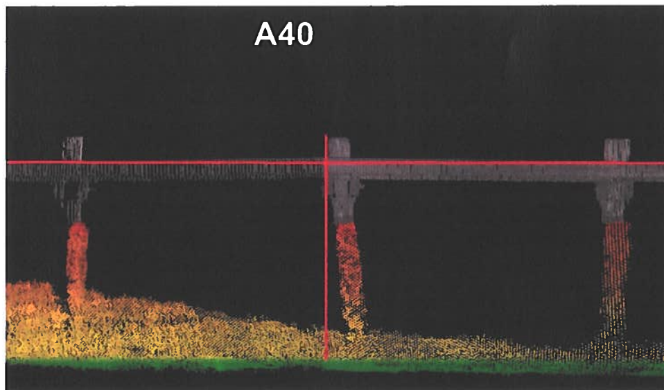
Abbildung 11. Signifikante Verformung an den Strukturen zwischen A36 und 42 (Hervorhebung)
