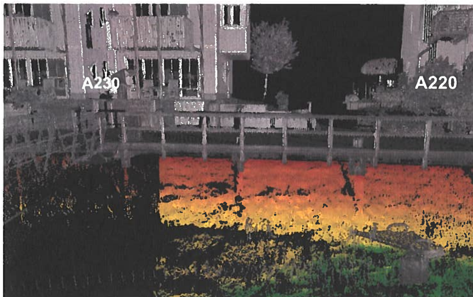
Abbildung 44. Signifikante Verformung an einem Pfahl an Position A226
