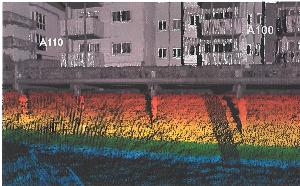
Abbildung 21. Leichte Verformung an einem Pfahl an Position A105
