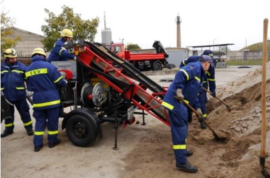
Abbildung 16 Mit vereinten Kräften und unter Zur- Hilfenahme der Sandsackfüllmaschine konnten in kürzester Zeit einige hundert Sandsäcke vorbereitet werden.
