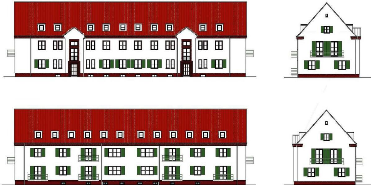
Abb. 32: Rekonstruktion einer Fassade mit auskragenden Balkonen
