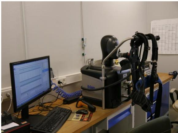
Abbildung 15: Die Prüfschritte werden durch den Rechner automatisch an den „Prüf-Kopf“ weitergegeben. Somit werden fehlerhafte Abläufe und Prüfungen ausgeschlossen.
