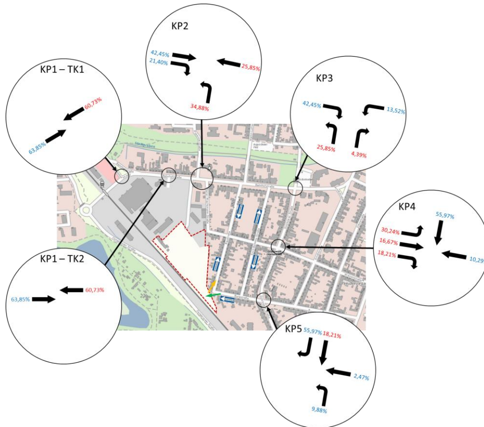
Abbildung 3 erwartete Verkehrsverteilung der Wohnerverkehre mit Einbahnstr. in der Burgstr. - prozentuale Anteile auf Gesamtquell- und -zielverkehr bezogen
