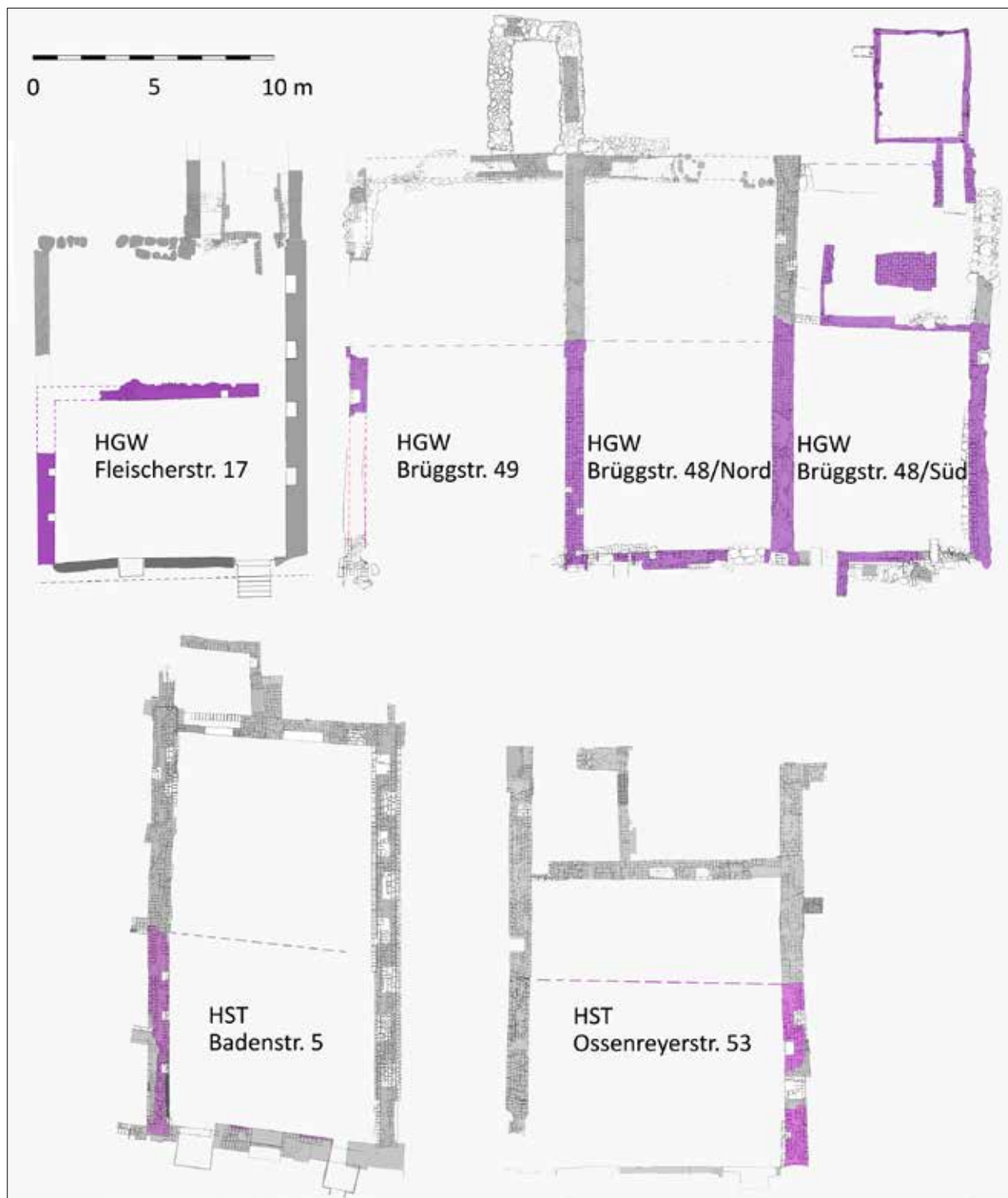
Abb. 15 Grundrissvergleiche von Backsteinkellern teilunterkellelter Giebelhäuser aus Greifswald und Stralsund. Farbige angelegt die erhaltenen Bauteile der Zeit um 1270/80. Kartierung: T. Rütz (2025)
